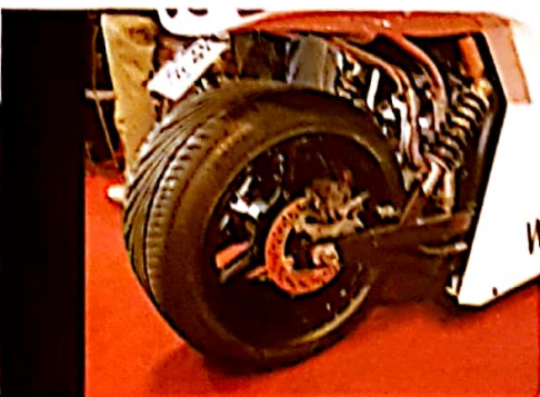
Napęd na tylne koło łańcuchem. Amortyzatory dostarczyła firma Wilbers.
